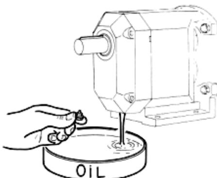
15. Nachdem des Pumpenkopf entfernt ist, Öl ablassen und Passfeder von der Welle nehmen.
