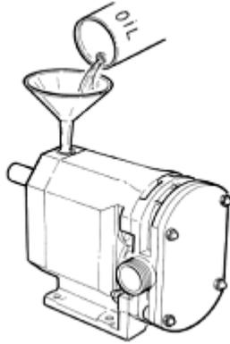
42. Triebwerksdeckel anbauen und auf das Einlegen des O-Rings nicht vergessen, Passfeder in die Welle einsetzen. Das Triebwerksgehäuse mit der in Tab. 10 angegebenen Menge Öl befüllen.
