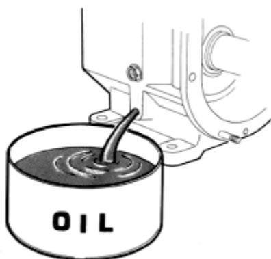
17. Nachdem der Pumpenkopf entfernt ist, Öl ablassen und Passfeder von der Welle nehmen.
