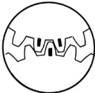
21. Zahnräder kennzeichnen, um die richtige Gleichlaufstellung beim Zusammenbau wiederzufinden.
