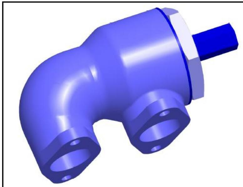
Abbildung 4: Sicherheitsventil (By-Pass)
